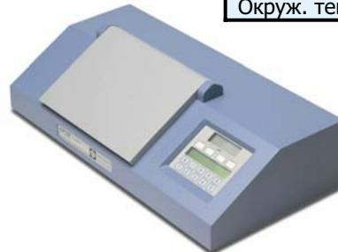
Также можно задать до пяти пользовательских шкал, в которых, например, можно задать простую зависимость между углом вращения и концентрацией оптически активного в-ва, что позволит использовать поляриметр как «концентратомер». Можно задать и пользовательский тип термокомпенсации.
