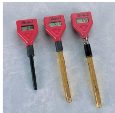
**CHECKER 1** - модель со сменным компактным рН-электродом HI 1270 с винтовым разъемом.
