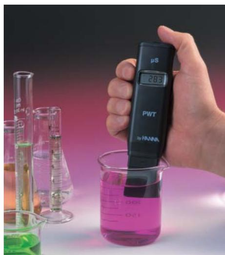
Чистота – важнейший фактор для использования воды как в лабораторных, так и в промышленных целях. **UPW** и **PWT** – идеальные определители чистоты воды во всех областях, где применяется дистиллированная и деионизованная вода (аналитика, электроника, химические реактивы, биологические исследования, медицина и т.д.).
